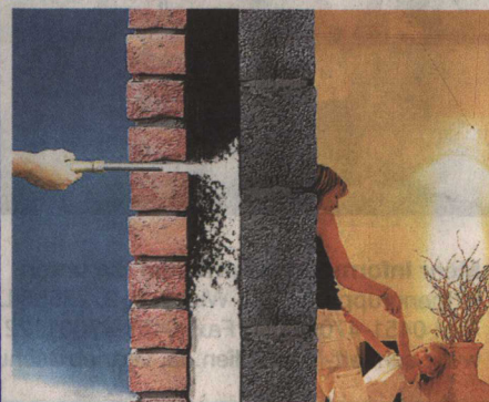
Effizient, aber nicht überall möglich: die Kerndämmung Hyperdämm & Bautechnik
